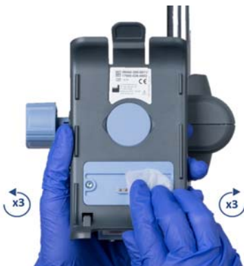
Figure 11.1. Nettoyage des connecteurs électriques
